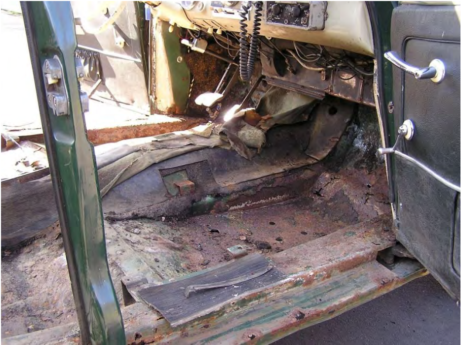
Foto: So sah es unter den Fußmatten des BMW 501 "Isar 12" aus: eine über neun Jahre andauernde Restauration im Polizeioldtimer Museum
